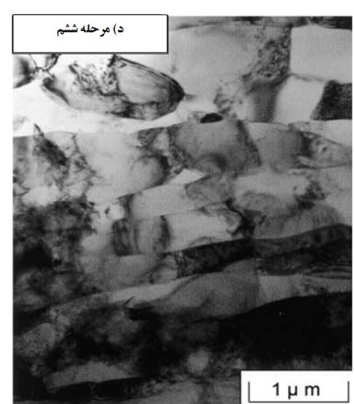
شکل (۵): ریزساختار نمونه‌ها در مقطع عرضی (TD) مشاهده شده توسط میکروسکوپ الکترونی عبوری (TEM) پس از: الف) مرحله اول، ب) مرحله دوم، ج) مرحله چهارم و د) مرحله ششم.
