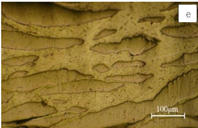
شکل ۲- تصاویر میکروسکوپ نوری از سطح مقطع عرضی نمونه‌های کامپوزیتی آلومینیم- تیتانیوم تولید شده پس از (a) ۱، (b) ۲، (c) ۴، (d) ۶، (e) ۸ سیکل از فرایند ARB
